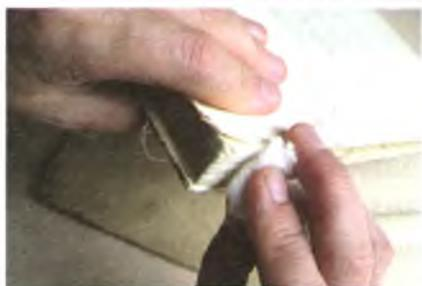
Очищаем корешок блока от лишнего старого клея.
