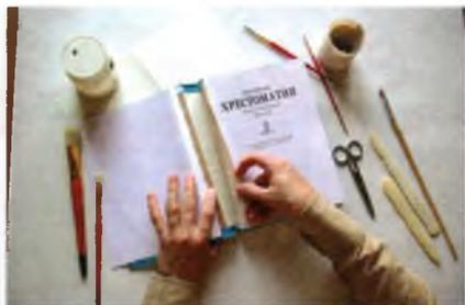
На переплётных крышках надо аккуратно отклеить форзац на ширину припусков — на 2 см.
